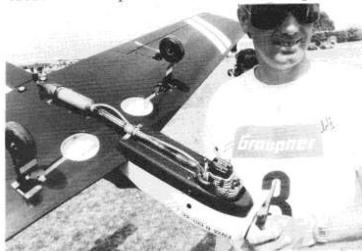
Heinrich Kronlacher fra Østerrike hadde stevnets kvasseste firetakter. Som vi ser på bildet er eksosanlegget avstemt. Motoren er en Enya 120, og modellen er Hanno Prettners "Supra-fly".
