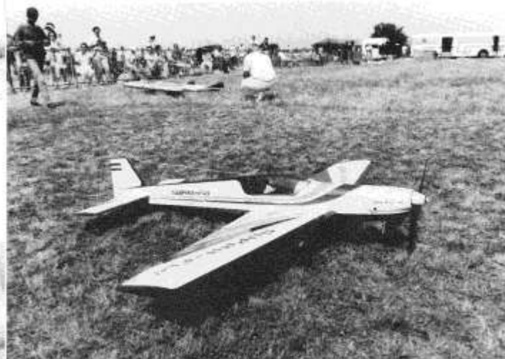
Heinrich Kronlacher fra Østerrike hadde stevnets kvasseste firetakter. Som vi ser på bildet er eksosanlegget avstemt. Motoren er en Enya 120, og modellen er Hanno Prettners "Supra-fly".
