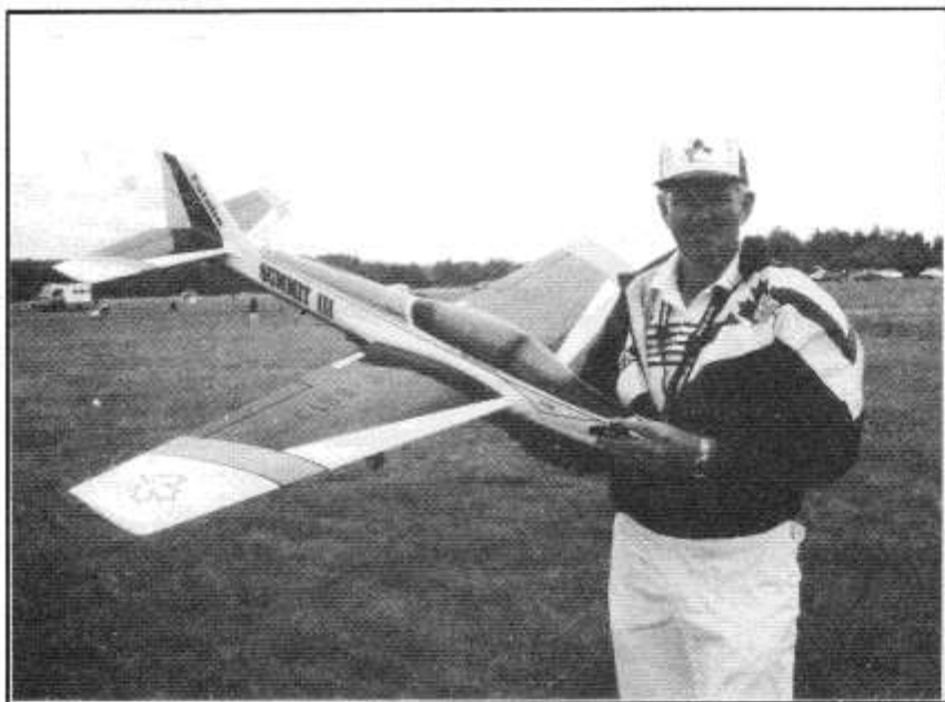
Ivan Kristensen tok tredje plass med denne nye utgaven av SUMMIT. Modellen har noe større kropp enn den forrige, men veier allikevel bare 3200 gram. Motor er YS 10 ccm.
