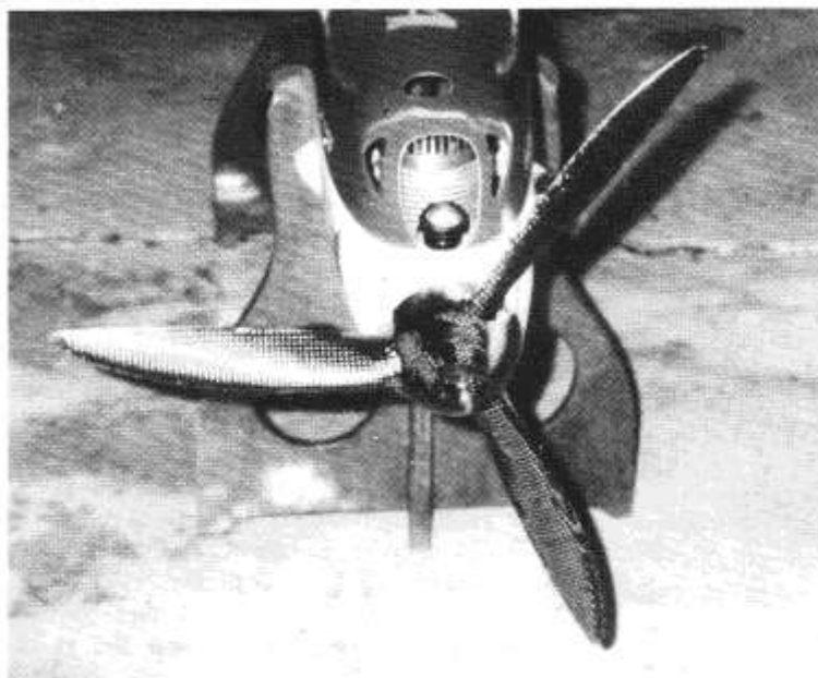
Tilbake til gamledager? 3-bladet propell er aktuelt igjen, her en 16x12 APC-kopi laget av karbonfiber. Modellen er Silvestris reservemodell, en Extrem fra ZN-line
