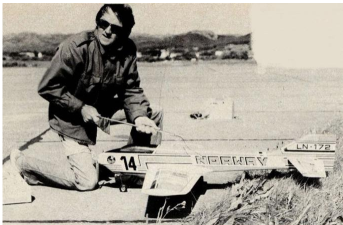
Ernst Totland pumper opp lufttrykket for understellsystemet på sin CURARE.
